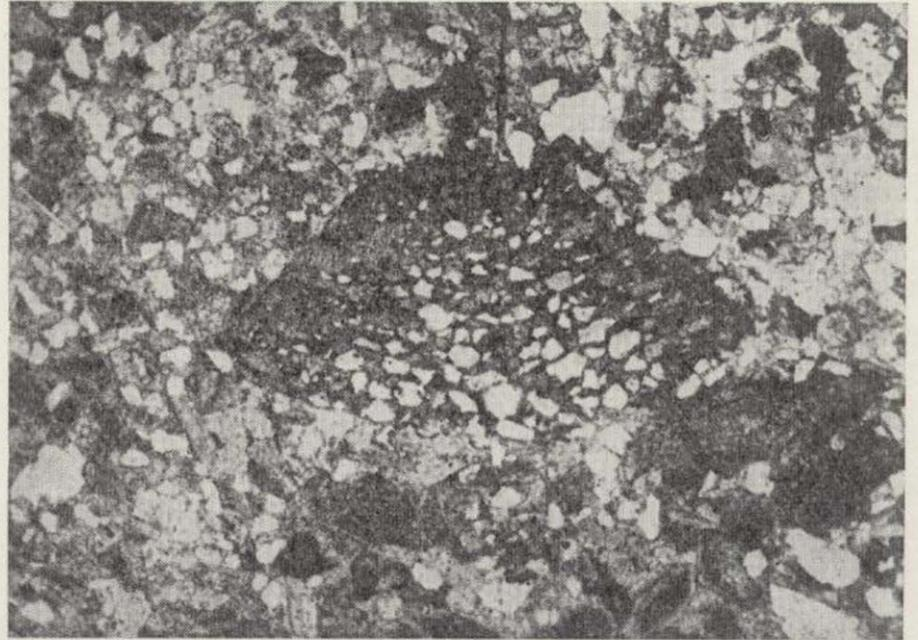
Muestra 643.—Caliza muy arenosa (caliza wackestone).
